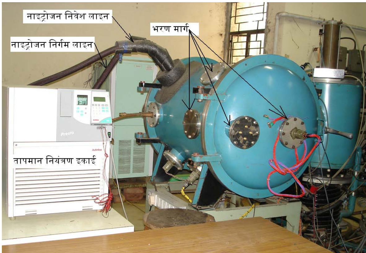
चित्र 8.1 उपग्रह के उपकरणों के लिए ताप निर्वात परीक्षण कक्ष
