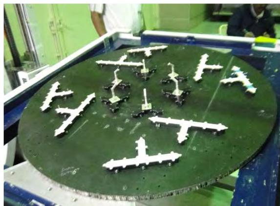
**चित्र-6** CFRP प्लेट के पीछे की ओर CFRP प्लेट के शीर्ष भाग पर फीडिंग नेटवर्क की पहली परत
