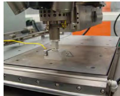
क्लोज्ड लूप फ़ोर्स फीडबैक एवं कन्ट्रोल प्रणाली को रीफ्लो प्रोफाइल में सफलता पूर्वक प्रोग्राम कर, की सतह के लिए धनात्मक दबाव की अनुकूल मात्रा के लिए अनेक प्रयोग किये गए।
