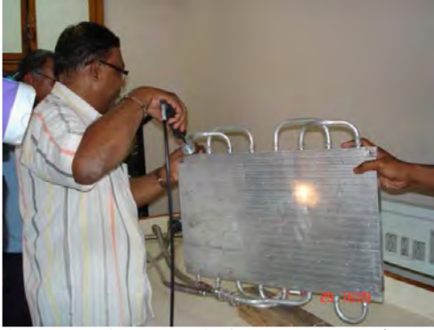
चित्र 5 : एकीकृत एलुमिनियम ऊष्मीय प्लेट पर रिसाव खोजक यन्त्र द्वारा परीक्षण
