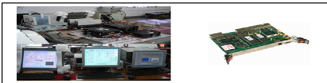
चित्र सं. 5: मेसर्स टाईडेन्ट इन्फोसोल के एकल - पटल संगणक COTS कार्ड और cPCI न्याधार (Chassis) का उपयोग करके जाँच करने की वास्तविक जाँच व्यवस्था।
