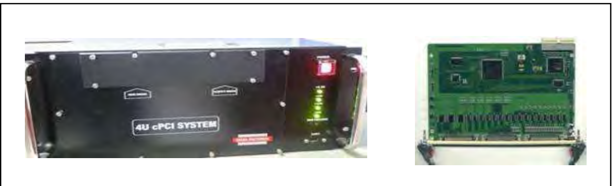
चित्र सं.1: मेसर्स डाटा पैटर्नस द्वारा विकसित भू-बहिर्गमन न्याधार (Chassis) एवं FPGA कार्ड।
