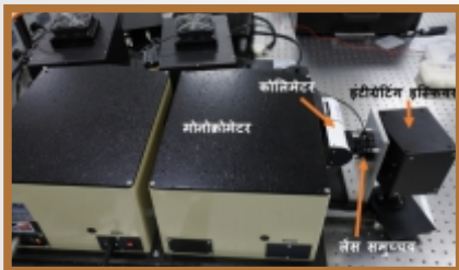
आकृति 5 : लेंस समुच्चय का वर्णक्रमीय अभिलक्षणन का परीक्षण सेट अप
